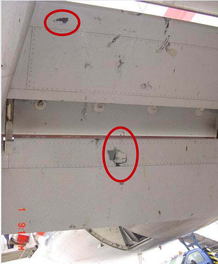
Daños a la ala
